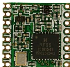
Figura 19: Módulo HopeRF RFM95W
