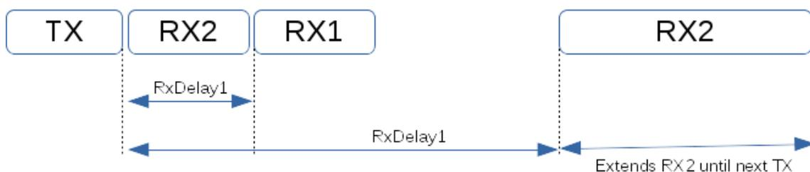
Figura 7: Comunicación dispositivos clase C
