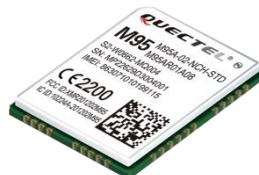
Figura 11: Módulo GPRS M95
