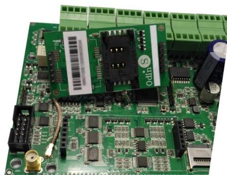
Figura 21: Diseño para tarjeta SIM de tecnologías celulares
