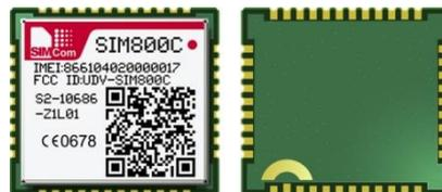
Figura 10: Módulo GPRS SIM800C
