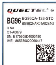
Figura 12: Módulo BG96 para LTE-M y NB-IoT
