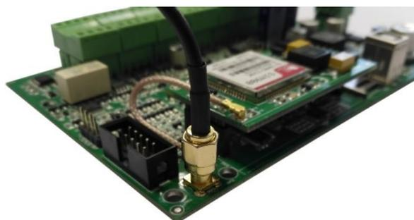
Figura 22: Conexionado de antena para módulos IoT
